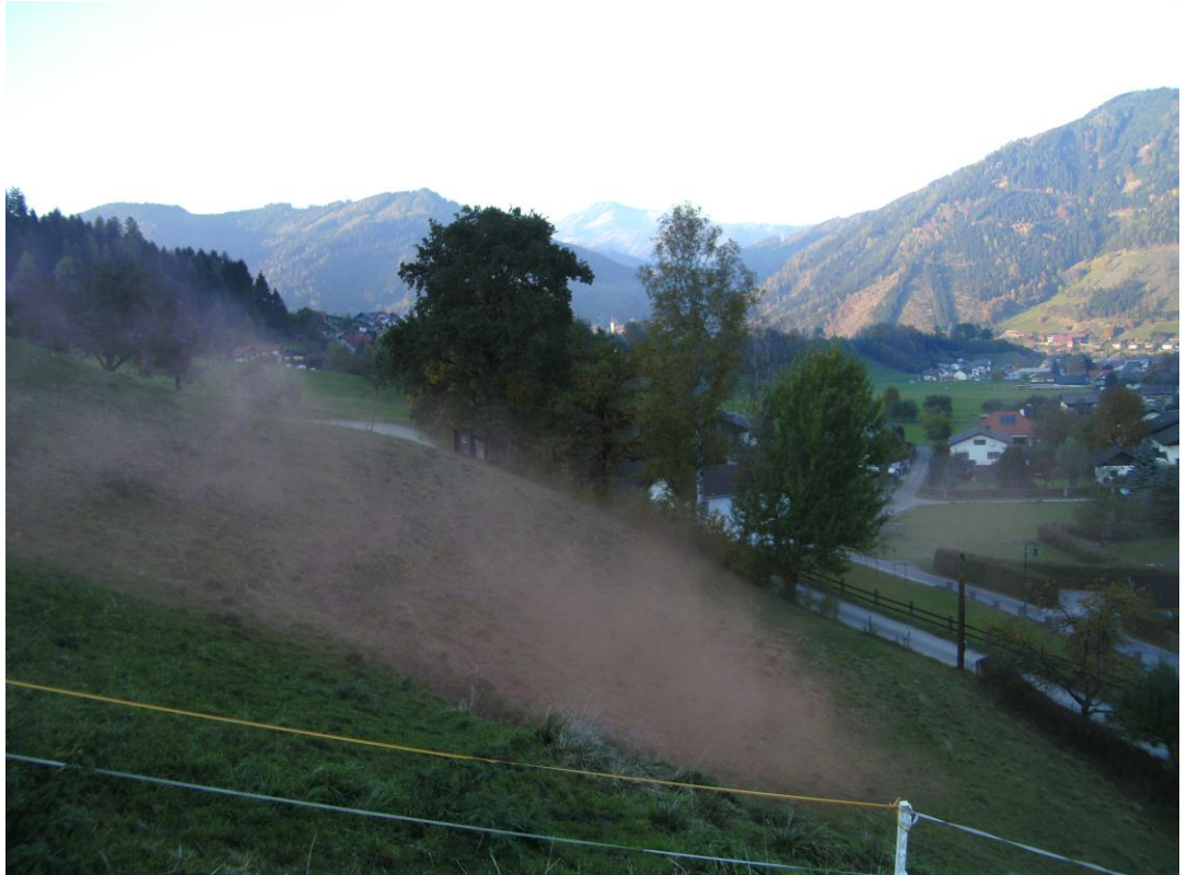
Abb. 4 : Aufnahme des Rauchpatronentests mit der Ausbreitung Richtung Nordost hangabwärts, die Rauchgasfahne schmiegt sich entsprechend der stabilen Schichtung an den Hang an, wobei die Turbulenz sehr gering bleibt; im Hintergrund gut erkennbar der weitere Verlauf des Utschtales und die Berge im Murtal
