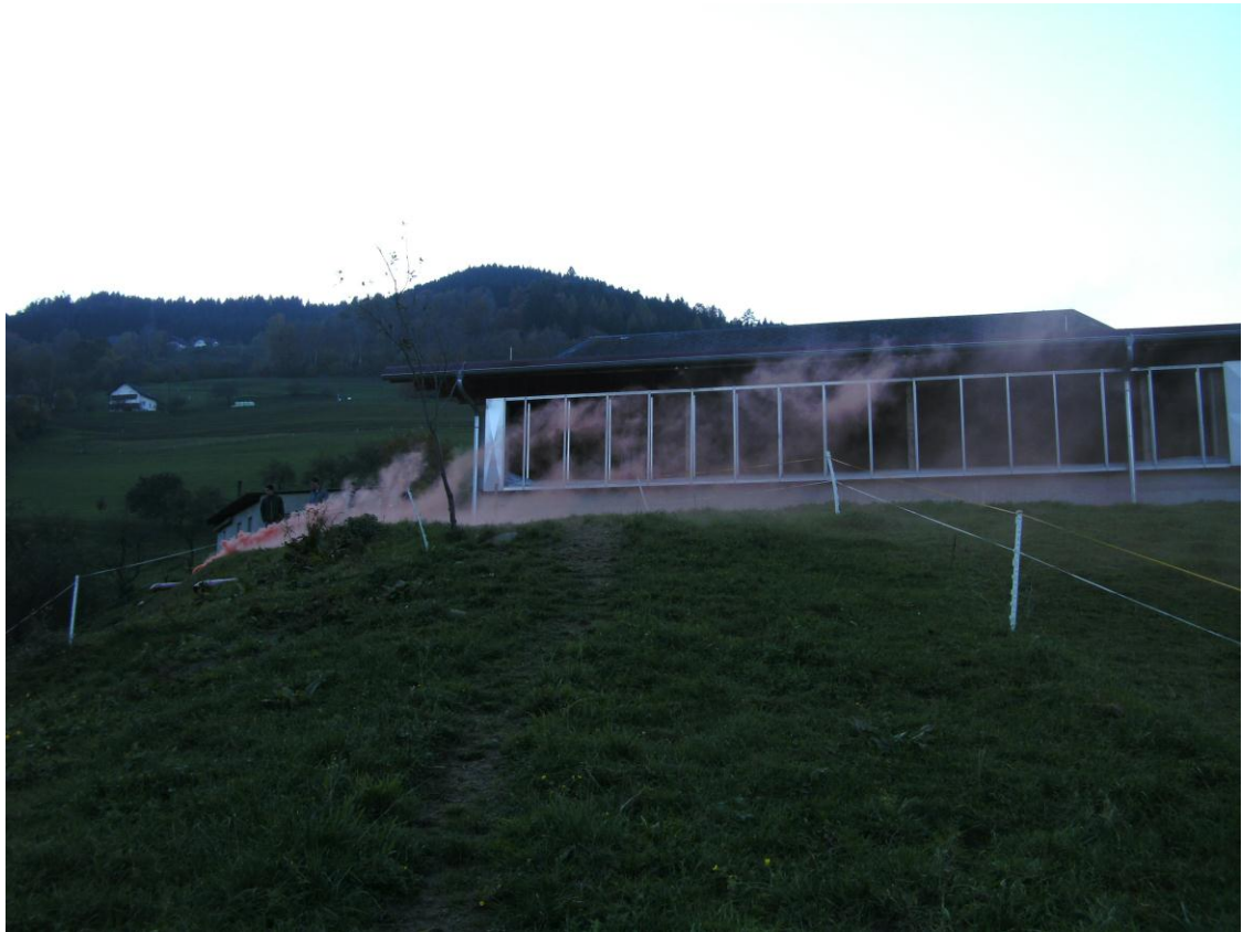
Abb.5: Ausbreitung der Rauchgasfahne mit Blickrichtung hangaufwärts (West Südwest) mit dem neuen Stall und seiner offenen Bauweise. Der Talauswind kommt im Bild von links aus südlicher Richtung und die Ausbreitung erfolgt praktisch talparallel.
