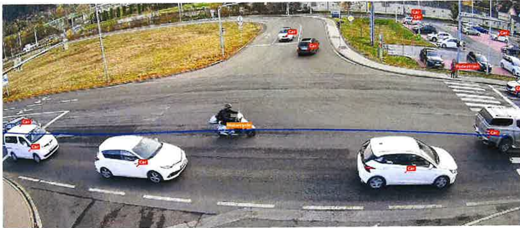
Abbildung 5: Erfassten Verkehrsteilnehmer, Beispiel Verfolgung (Trajektorie) Motorrad
